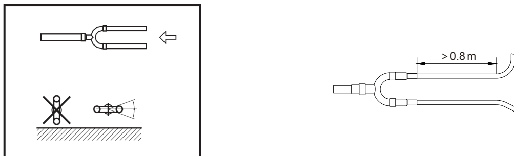
Fig. 4-7 Instalación del distribuidor
